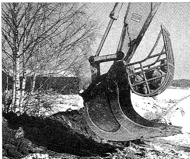
Mo-Dig-skopan med utfällt sorteringsgaller
